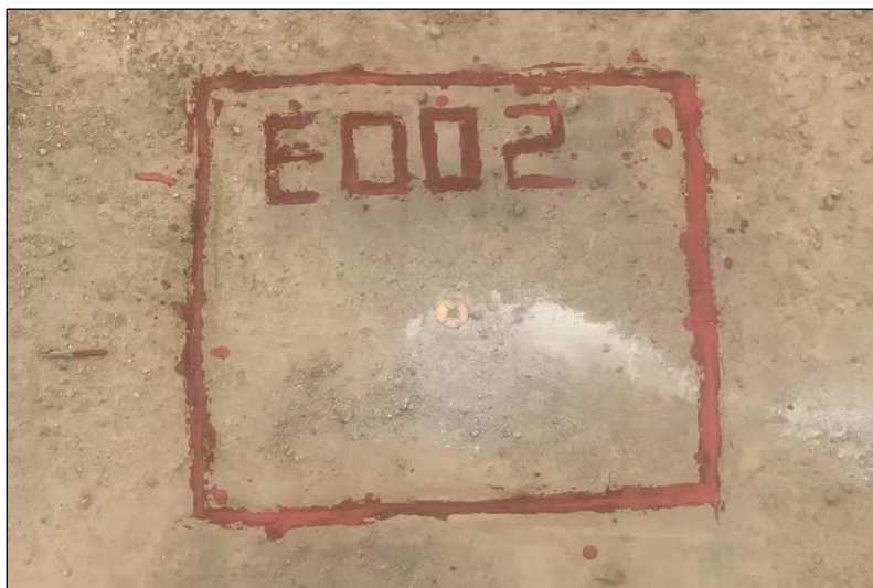
照片 3.6-1 E 级控制点 GPS1
