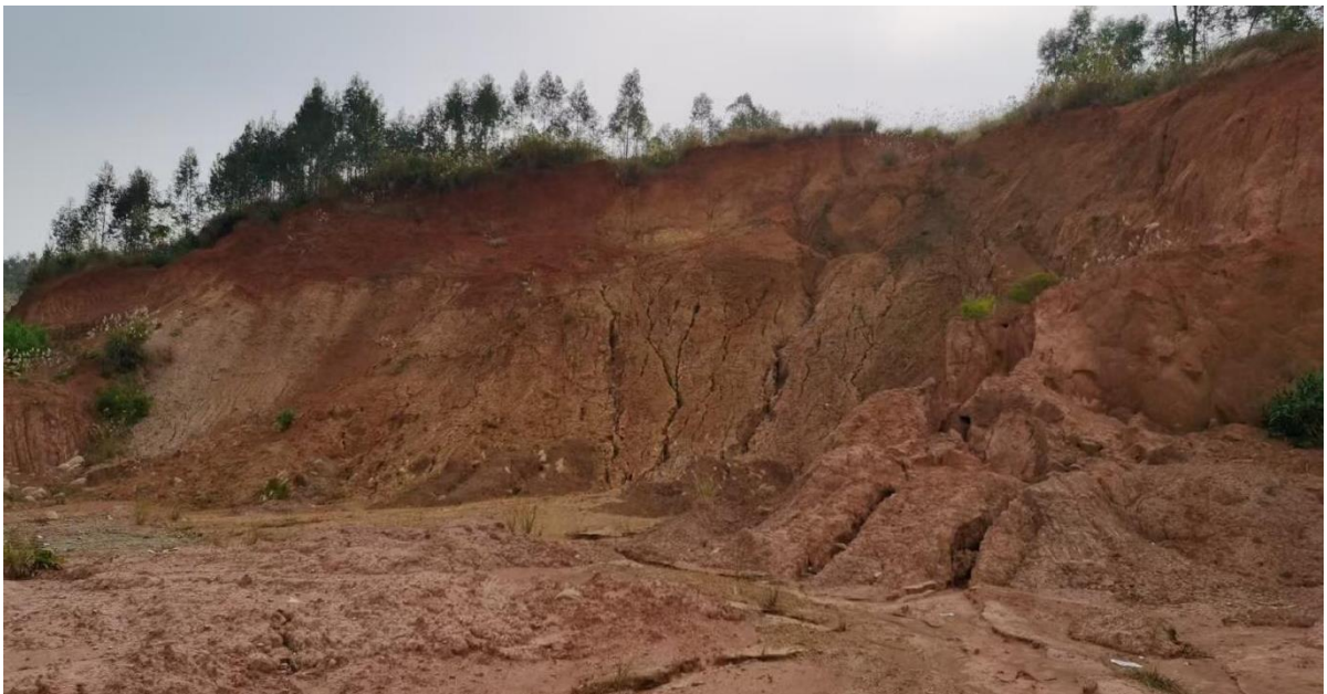
图 5.1-4 采场西南面山体崩塌 B1（镜向 140^{\circ} ）
